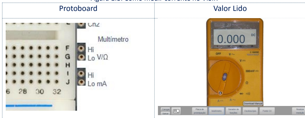
Figura 1.8: Como medir corrente no VISIR
