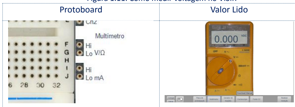
Figura 1.11: Como medir voltagem no VISIR
