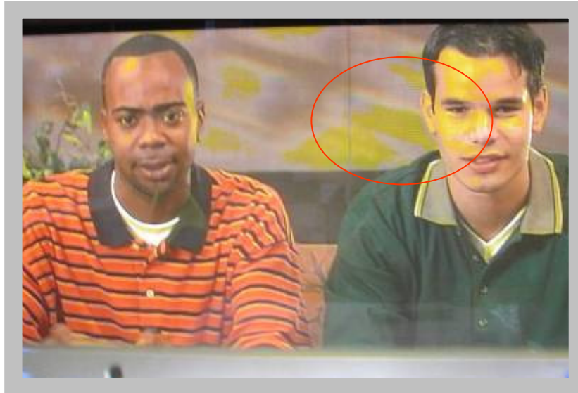
Defeito de cintilação
