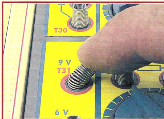
Ao deslocar-se a mola, fica um espaço oco para passar o fio.
