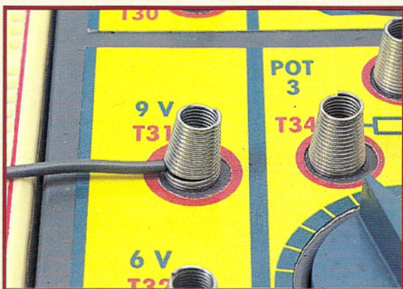
Ao soltar a mola, o fio fica preso e o contato assegurado.
