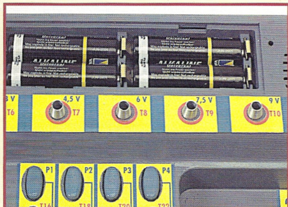
Dispõe-se de conexão de alimentação de até 9V em saltos de 1,5 volts.
