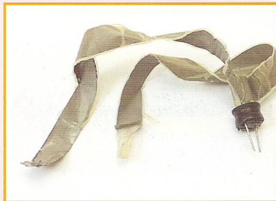
O capacitor eletrolítico consiste em duas lâminas de alumínio e uma lâmina porosa, impregnada de dielétrico.
