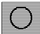
Trimpot de linearidade ajustado corretamente
