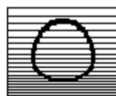
Trimpot de linearidade desajustado
