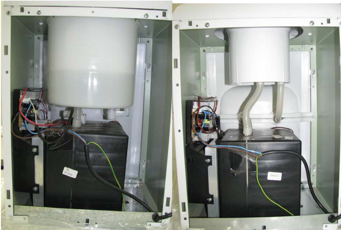
Figura XLVIII: Modificação na cuba do bebedouro: projeto antigo e projeto novo
