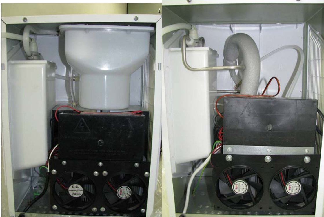
Figura L: Modificação na cuba do purificador: projeto antigo e projeto novo
