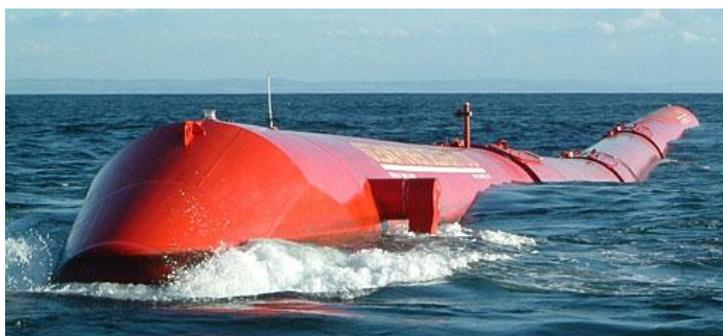
Figura 2.10 – Aspecto do Gerador Pelamis, Instalado na Póvoa do Varzim. (Pelamis Wave Power, 2009).
