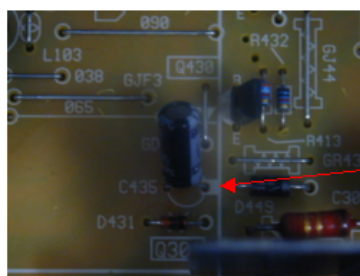
Modo como foi montado o capacitor C435.
